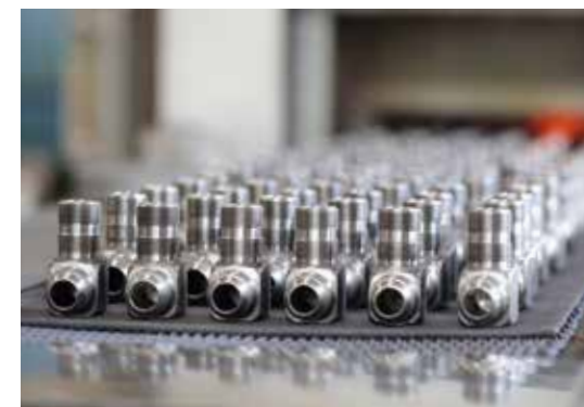
▲ 都城工場は主に炉中ロウ付け継手製品を製造しています。
